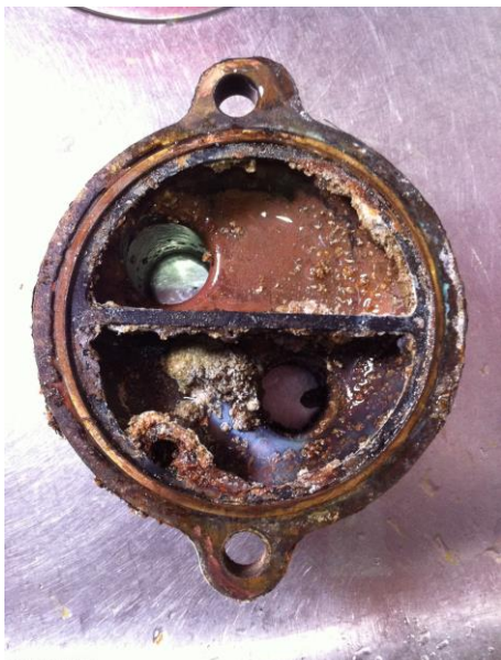
Le nettoyage de l'échangeur n'est pas superflu...
